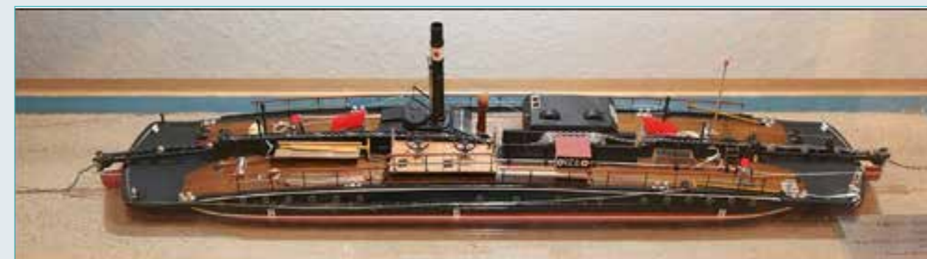
Туер (от фр. toueur ) или цепной пароход — особый вид речного судна, буксир, движущийся вдоль уложенной по дну цепи или троса. Туеры появились в первой половине XIX века. С начала XX века их начали вытеснять другие типы судов, и к 30-50 годам они практически перестали использоваться.
